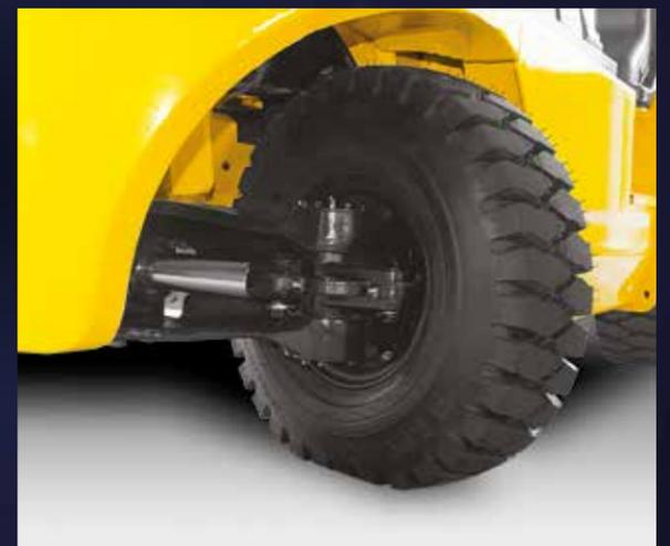
L'essieu arrière est conçu pour un usage intensif avec des roulements coniques pour une durabilité accrue.
