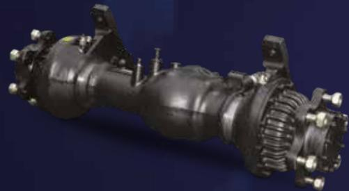
L'essieu moteur est équipé d'un réducteur planétaire qui permet d'assimiler les changements de couple. Les freins à disques humides garantissent une performance de freinage optimale quelle que soit l'application. Grâce aux intervalles d'entretien prolongés, le système de freins à disques humides réduit les coûts d'entretien et les temps d'arrêt.
