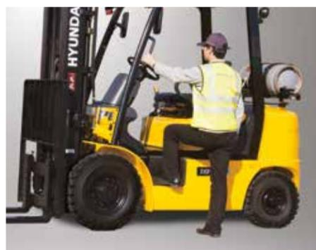
Le seuil d'entrée est bas et la poignée sur le toit facilite l'accès à la machine.
